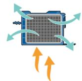
L'air est soigneusement purifié dans le filtre alvéolé céramique. Un ventilateur silencieux renvoie l'air épuré dans la pièce.
